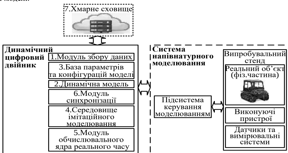
Рисунок 3 — Узагальнена структура динамічного цифрового двійника для напівнатурного моделювання транспортних засобів
