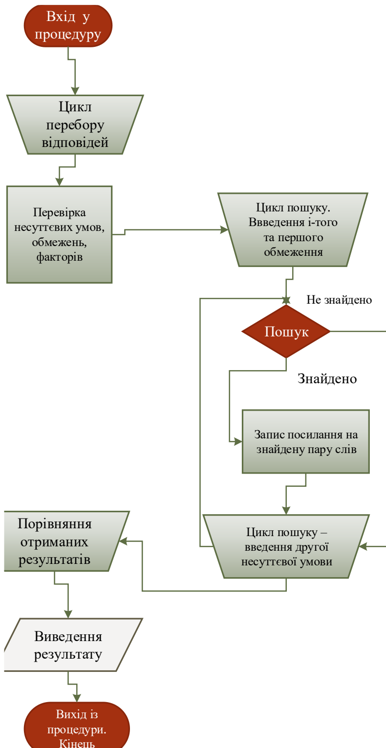
Рисунок 6 — Блок-схема третьої процедури виконання адаптаційного алгоритму
